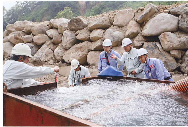
現場担当者の説明を聞きながら排水量のチェックを行う脇本と野原
